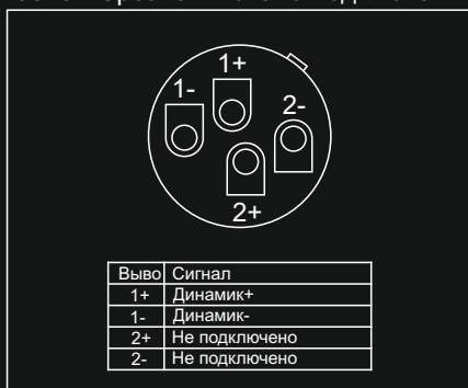
Разъем Speakon и схема подключения
