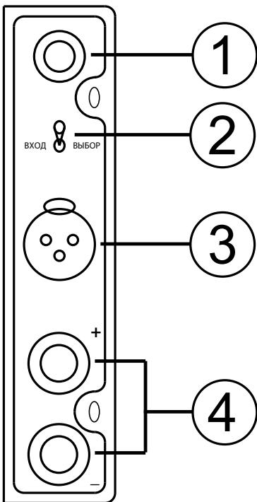
*Примечание: Каждый канал усилительного модуля имеет отдельные симметричные и несимметричные входы и независимый переключатель селектора входа.*
