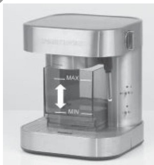
Шаг 3: Наполните резервуар раствором для удаления накипи. Не наполняйте резервуар выше отметки максимума (MAX)!
