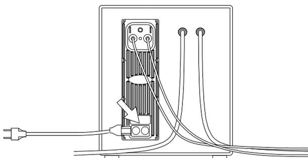
Collegate il subwoofer alla rete elettrica attraverso il cavo in dotazione. Inserite l'estremità opportuna del cavo nella presa di rete; inserite l'altra estremità con il connettore POWERCON, nella apposita presa di alimentazione BLU situata nella parte posteriore di K3st Sub
