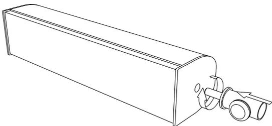
Prendete un K3st TOP, avvitate l'adattatore a bicchiere nell'apposita filettatura situata nella parte inferiore della cassa. Ripetete l'operazione per l'altro K3st TOP
