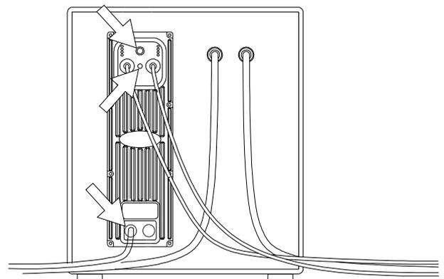
Verificate che il volume sia al minimo e ruotare il connettore POWERCON di alimentazione. Ora selezionate il preset desiderato, quindi regolate il volume a vostro piacimento (\*)
