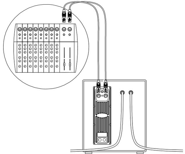
Collegate K3st SUB alla vostra sorgente sonora attraverso le prese INPUT-L e INPUT-R situate sul pannello controlli posto nella parte posteriore del sub
