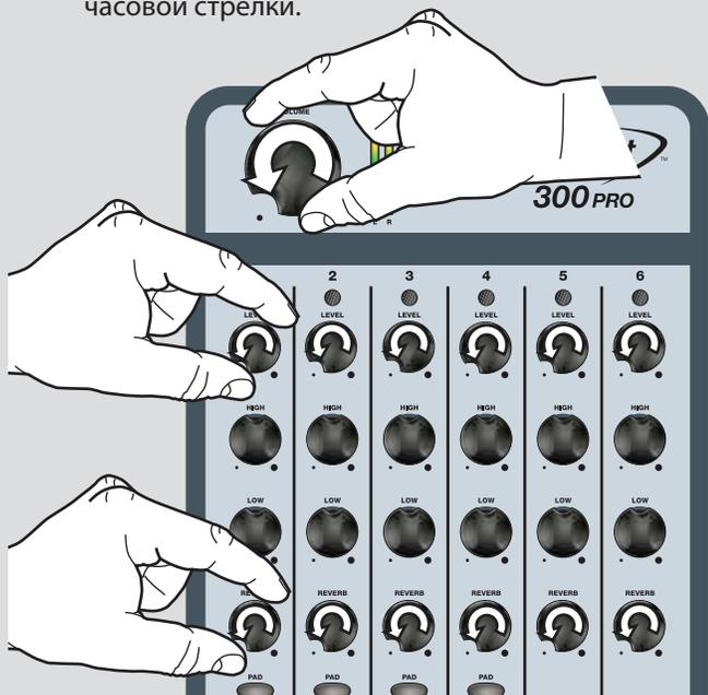
7. Включите вначале все подключенное к Passport оборудование, а затем включите Passport. Светодиодный индикатор питания на Passport должен загореться зеленым цветом (Индикатор защиты включится на короткое время)
