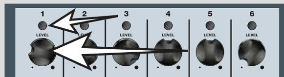
10. Настроить остальные каналы аналогичным способом. Для регулировки относительного уровня громкости каждого канала используйте ручки Уровня канала. Регулировку выполняйте до тех пор, пока не получите соответствующий баланс. Затем используйте мастер ручку громкости для общей регулировки уровня сигнала. На мастер ручке громкости имеется индикатор уровня сигнала. Если вы видите, что индикаторы горят в красной зоне, необходимо вернуть мастер ручку громкости.
