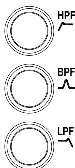
**[19] Изменение типа фильтра.** Нажмите одну или несколько кнопок типов фильтра HPF, BPF и LPF, чтобы поэкспериментировать с различными эффектами. Например, нажатие HPF и LPF вместе производит notch-эффект. Как только Вы ознакомитесь с широкими возможностями этих фильтров, включайте их в свой арсенал на представлениях.
