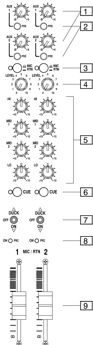
**1 Посылы Aux 1-2.** Настраивают уровень сигнала канала, поступающего на выход Aux. Полнотью поверните ручку против часовой стрелки для выключения сигнала и по часовой - для максимального подъема +6dB.
