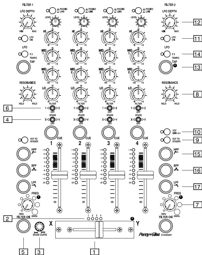
**[1] VCA кроссфейдер.** XONE:92 использует четыре управляемых напряжением усилителя (VCA), пара для каждой стороны стерео кроссфейдера. Прочный 45мм фейдер дает DC напряжение, определяющее уровень сигнала VCA. Напряжение фильтруется для предотвращения шума или щелчков. Данное преимущество не имеет силы, если сигнал маршрутизирован через обычный аудио фейдер.
