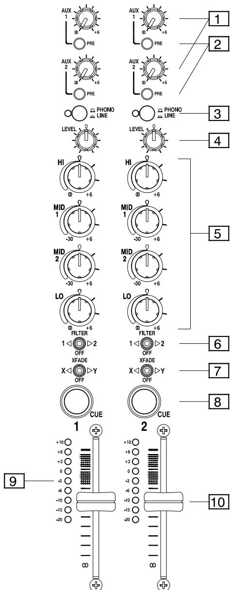
**1 Посылы Aux 1-2.** Настраивает уровень сигнала канала, поступающего на выход Aux. Полностью поверните ручку против часовой стрелки для выключения сигнала и по часовой - для максимального подъема +6dB.
