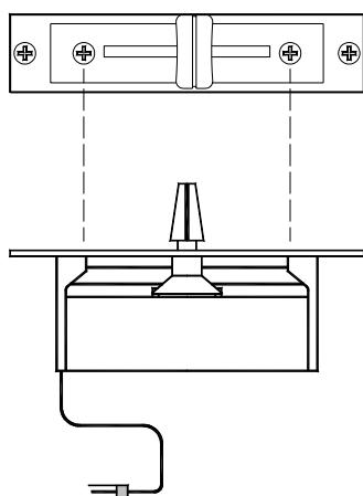
С помощью средних размеров крестовой отвертки открутите два внешних шурупа на панели кроссфейдера. Не выкручивайте внутренние шурупы. Аккуратно вытащите кроссфейдер из микшера. Отключите кабель от старого кроссфейдера и подключите к новому. Проверьте правильность и полноту вставки кабеля в разъем. Замените кроссфейдер, проверив размещение кабеля в левой части консоли. Закрутите шурупы и проверьте работоспособность системы.
