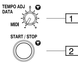
1 Управление TEMPO ADJ / DATA. Применением этого управления по умолчанию является настройка скорости с помощью кнопки темпа VCF 2 TAP TEMPO 3. В среднем положении регулировки скорость Clock не подвергается воздействию. Поверните против часовой стрелки для уменьшения и по часовой - для увеличения скорости Clock. Это позволяет внешним секвенсорам или drum-машинам аккуратно выравниваться с BPM предварительно записанных треков.
