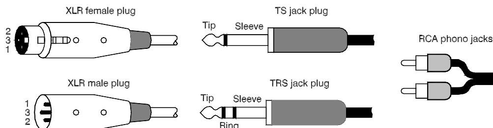
Разъемы входа и выхода XLR - 3-жильные, дифференциально симметричные. Имеют 3 пина: Pin 1 = земля (экран), Pin 2 = горячий (+), Pin 3 = холодный (-).
