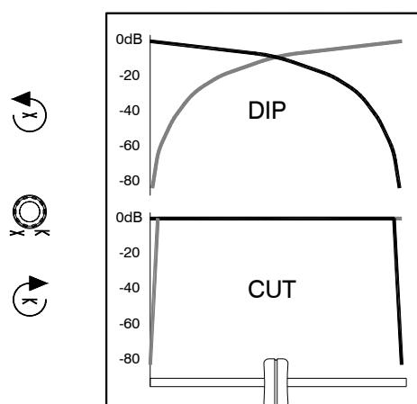
**8 Регулятор RESONANCE.** Предназначен для изменения ширины полосы 'Q' или 'остроты' фильтров. В минимальном значении MILD фильтры имеют мягкое "колено", дающее плавный, нежный ответ. При повороте по часовой стрелке в положение WILD они производят резонансный подъем обратой связи вокруг среза, вызывая резкие, яркие эффекты. Звук варьируется в зависимости от выбранного типа фильтра. Для избежания нежелательных результатов рекомендуется начинать эксперимент со звуком в нижнем положении RESONANCE.
