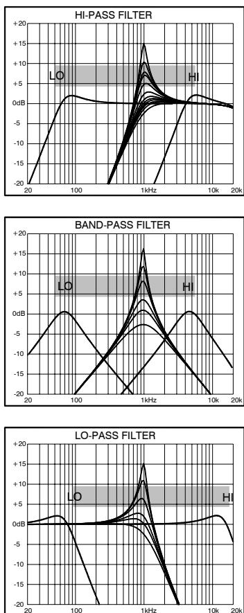
**11 HPF.** Нажмите эту кнопку для выбора фильтра high-pass. Частоты ниже точки среза вырезаются. Точка среза настраивается с помощью большого регулятора VCF. На минимуме слышен маленький эффект, т.к. удаляются только нижние частоты. Поверните по часовой стрелке для постепенного удаления линии баса. Самая верхняя частота ограничена 10kHz, т.к. выше этого порога мало, что слышно.
