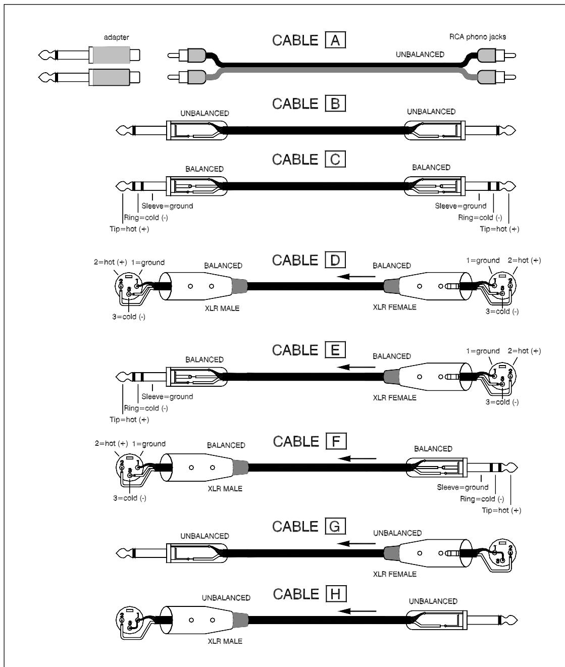
**1 Микроф. вход CH1-2.** Симметричный XLR. Подключите сюда микрофон. Используйте микрофоны хорошего качества с низким сопротивлением, такие как, например, которые предназначены для вокала. Не используйте несимметричные микрофоны и с высоким сопротивлением или конденсаторные микрофоны, требующие фантомное питание. Используйте профессиональные симметричные кабели CABLE D .
