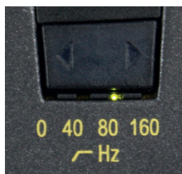
Abbildung 3: Wahlschalter für Tiefenabsenkung
