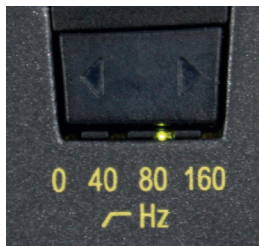
Figura 3: Conmutador-selector para atenuación de bajos
