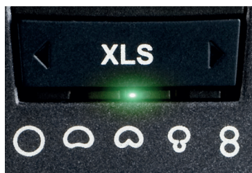
Abbildung 1: Wahlschalter für Richtcharakteristiken
