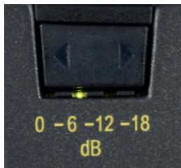
Figura 2: Conmutador-selector para preatenuación
