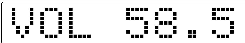
BasX PT-100 имеет большой, яркий, легко читаемый VFD (вакуумный флуоресцентный дисплей), который постоянно информирует пользователя о текущем состоянии устройства.
