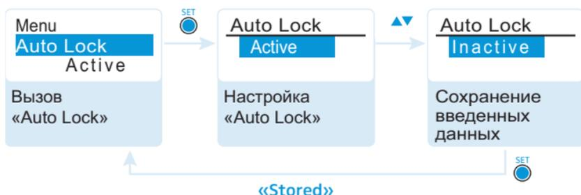
Эта блокировка предотвращает случайное выключение передатчика или выполнение изменений. В текущей стандартной индикации символ замка
