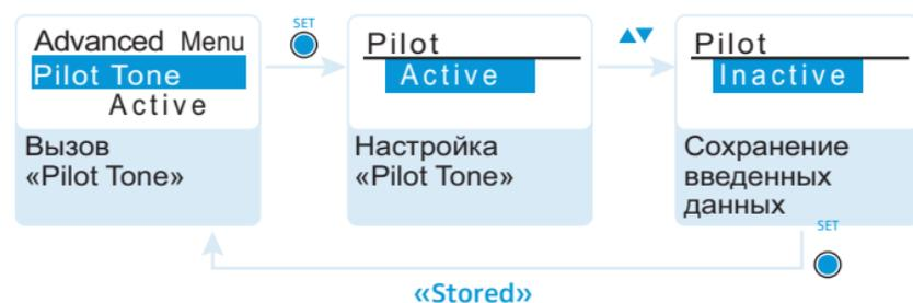
Пилот-сигнал имеет неслышимую частоту, которая передается передатчиком и обрабатывается приемником. Он поддерживает функцию шумоподавления (Squelch) приемника.
