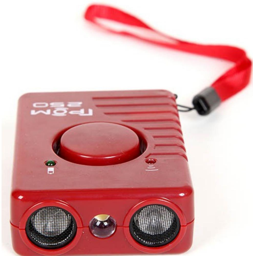
На переднем торце корпуса расположены 2 ультразвукового излучателя и сверхяркий светодиод. Эту часть корпуса прибора нужно направлять на четвероногих агрессоров, если Вы решили отпугнуть их.
