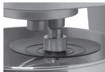
Draai de snelkoppeling met de klok mee op het Schroefdraad.
