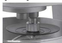
7. Monte la herramienta según lo siguiente: Mueva el mandril hacia arriba. Coloque el extreme cuadrado de la herramienta hasta el tope del husillo. Gire el mandril de suelte rápido en sentido de las agujas del reloj en el roscado de la herramienta.
