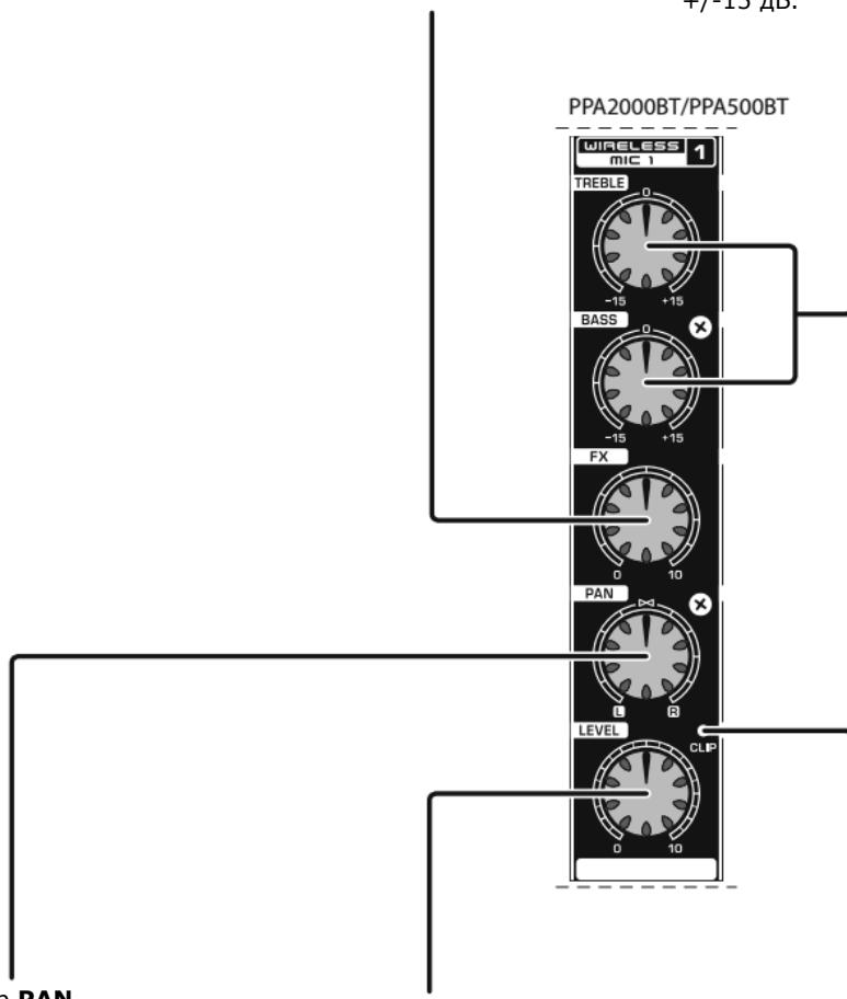
Регулятор **PAN** позиционирует сигнал каждого канала в стерео поле.
