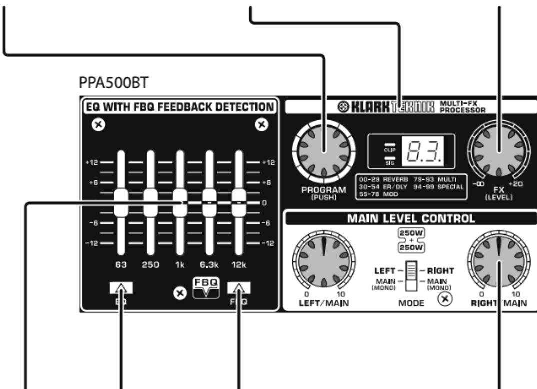
Графический эквалайзер для контроля некоторых специфических частотных полос звукового спектра.
