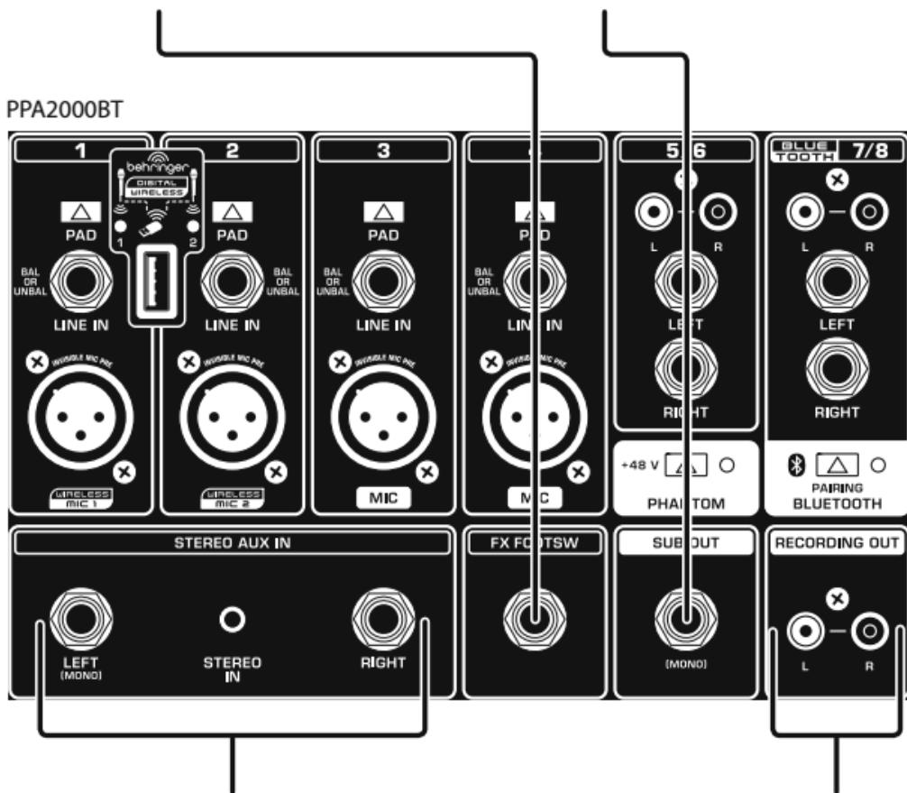
Входные разъемы **STEREO AUX IN** направляют сигналы подключенного источника непосредственно в основной микс. Источник сигнала подключается кабелем с разъемами 1/4" джек к гнездам LEFT и RIGHT или кабелем с разъемом 1/8" стерео джек к гнезду **STEREO IN**.
