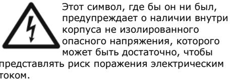
Этот символ, где бы он ни был, предупреждает о наличии внутри корпуса не изолированного опасного напряжения, которого может быть достаточно, чтобы представлять риск поражения электрическим током.
