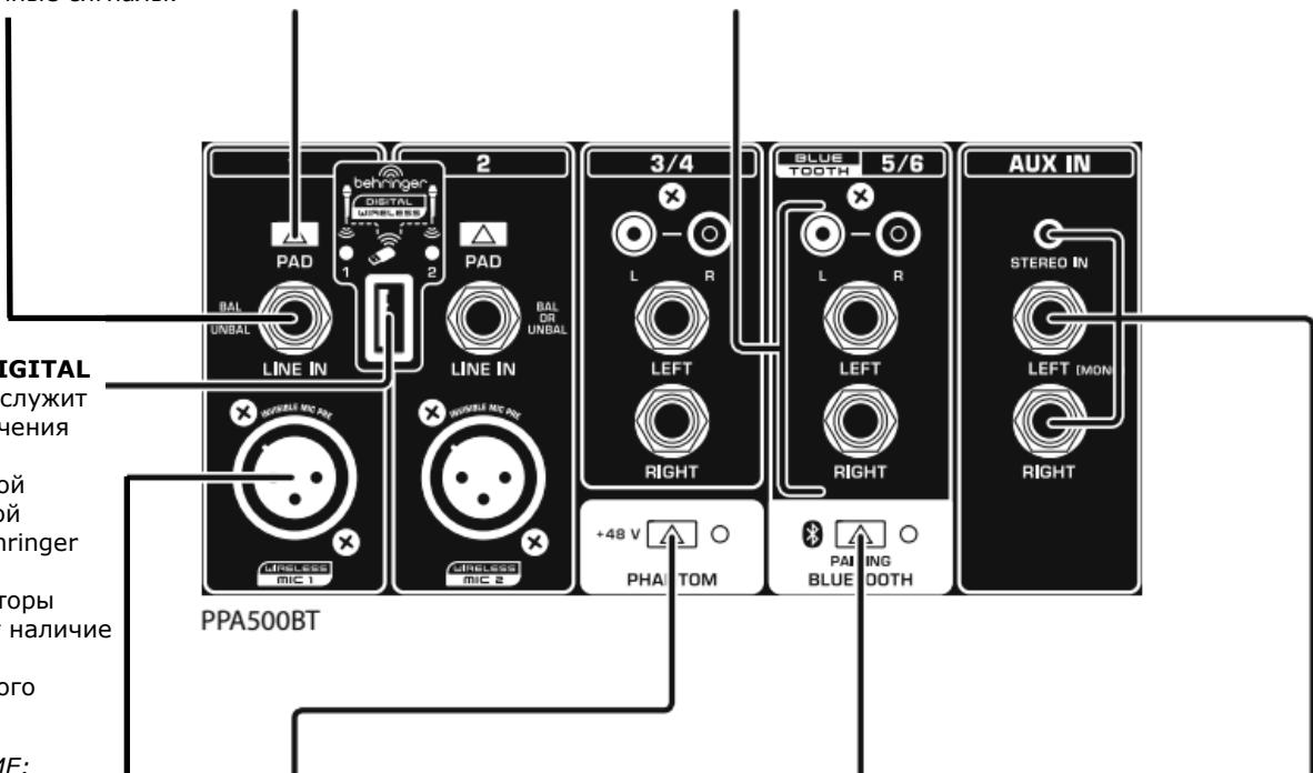
USB вход **DIGITAL WIRELESS** служит для подключения приемника беспроводной микрофонной системы Behringer (опция). LED индикаторы отображают наличие сигнала беспроводного микрофона.
