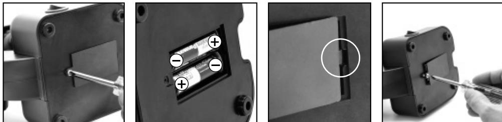
Для наблюдений с электронной подсветкой (6) вставьте 2 батарейки АА 1,5 В в батарейный отсек (8), расположенный в основании микроскопа (7). Батарейный отсек можно открыть с помощью крестовой отвертки. При установке батареек соблюдайте полярность (обозначена знаками +/−). Затем поставьте крышку батарейного отсека на место, сначала вдвинув выступ крышки в маленький паз, и закрутите винт.
