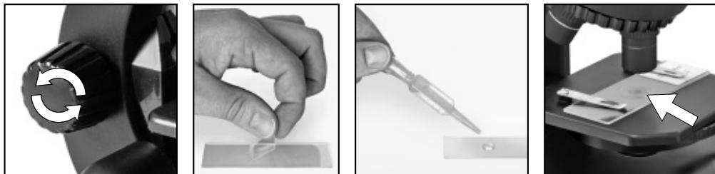
Поставьте микроскоп в хорошо освещенное место, например у окна или рядом с настольной лампой. Выберите объектив (3) с наименьшим увеличением и поворачивайте ручки фокусировки (2) до тех пор, пока оптическая трубка не будет на максимальном расстоянии от предметного столика.
