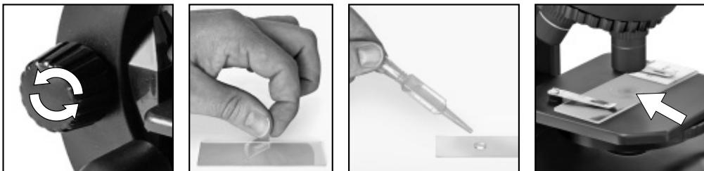
Voor de normale observatie zet je de microscoop op een goed verlichte plaats (raam, bureaulamp). Draai de scherpteregeling (2) tot aan de bovenste aanslag en stel de objectiefrevolver (3) op de kleinste vergroting in.
