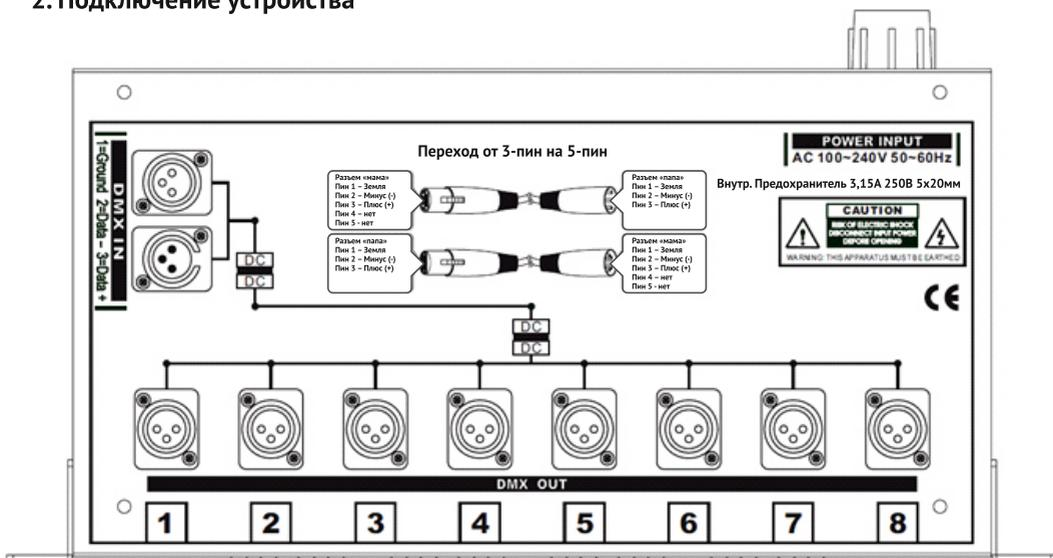
Вход DMX: подключите устройство, передающее сигнал DMX
