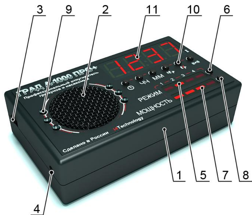
Рисунок 2 – расположение основных частей изделия
