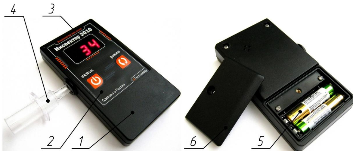
Рисунок 2 – внешний вид и расположение основных частей изделия
