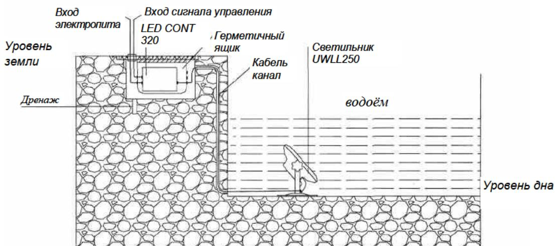
1. Не устанавливайте LED CONT 320 и контроллер или блок питания в воде. Установка производится выше уровня воды, в герметичном ящике.
