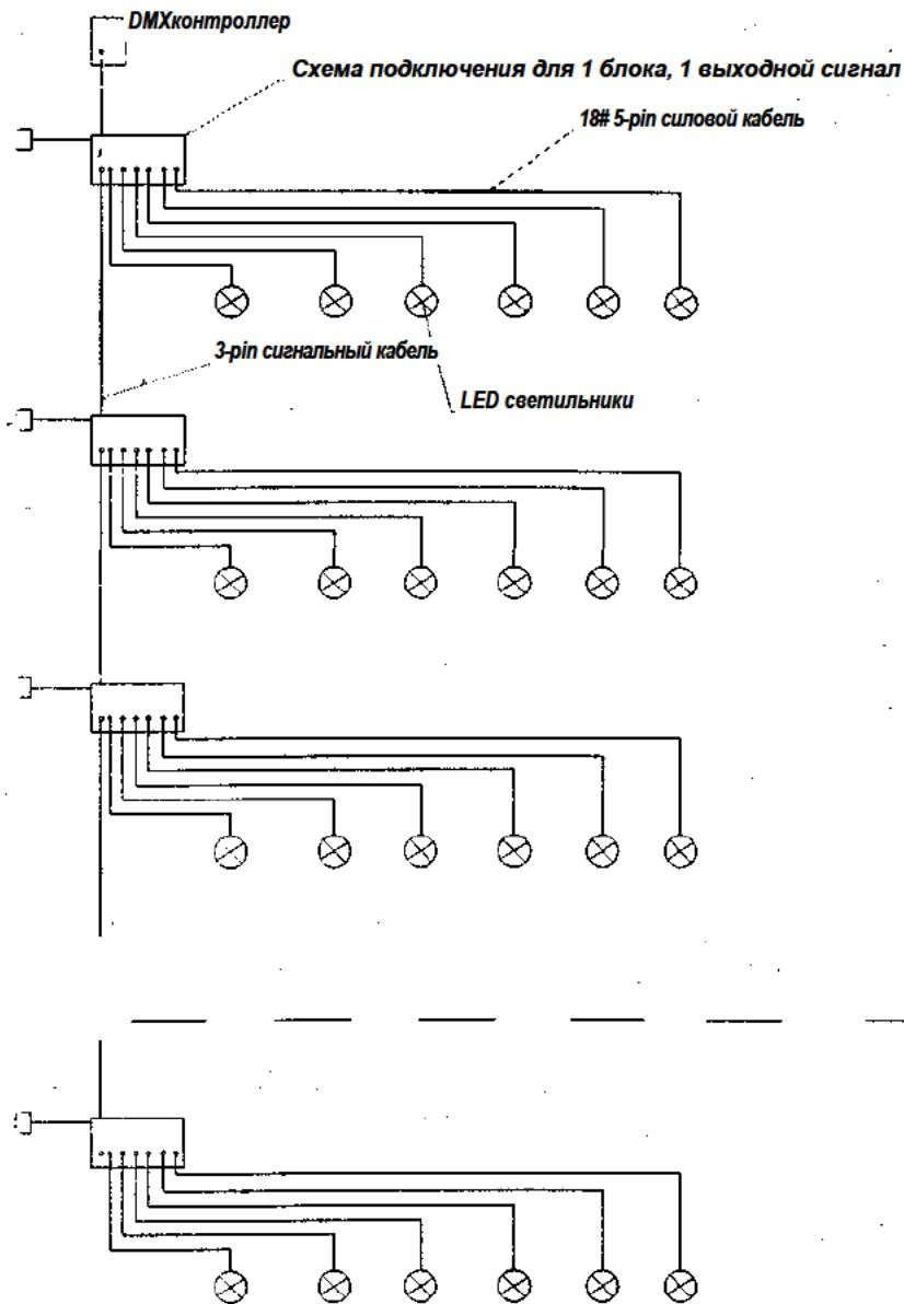
UWLL250, схема подключения для LED CONT 320, с выхода
