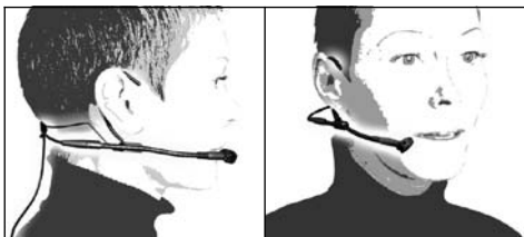
Fig. 7 : Réglage du col-de-cygne
